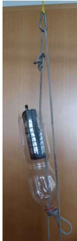
Bild 3: Behälter mit Batlogger und Aufzugsvorrichtung
